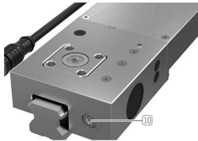
Das Element bietet die Möglichkeit, bei einem Ausfall der Elektrik, manuell geklemmt oder geöffnet zu werden. Dazu befindet sich an der Stirnseite der Exzenterwelle die Notbetätigung (10) mit einem Innensechskant. Hier kann das Element mit einem Innenschlüssel bewegt werden.
