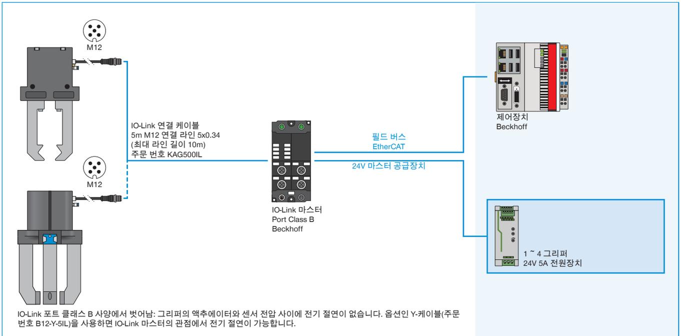
▶ IO-LINK 마스터 IP67로 연결되는 GPP5000IL / GPD5000IL(IO-LINK) 배선(SIEMENS)
