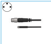
MFS02-S-KHC-P1-PNP 자기장 센서 직선, 케이블 0.3m-커넥터 M8
