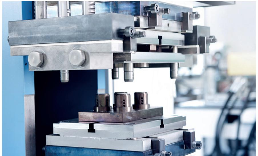
Junto con el proceso de moldeo por transferencia, en el que el elastómero se mete en un molde, se comprime para darle forma y se vulcaniza con presión y calor, también empleamos el proceso de moldeo por transferencia e inyección. En este caso, la materia prima se mete a presión en el molde a través de una inyectora y se vulcaniza.
