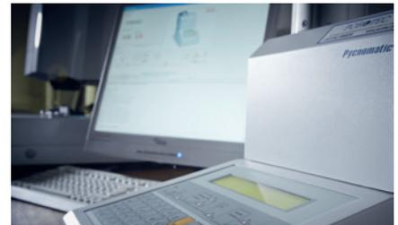
Picnómetro de gas para la medición de la densidad del material de sus piezas.
