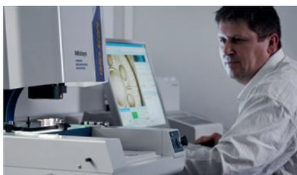
Equipo de medición óptico para la verificación dimensional de las medidas de sus piezas.
