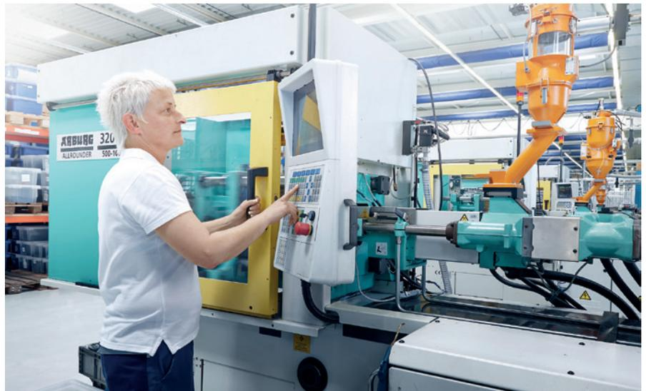
Nuestra fabricación por inyección emplea en todos los aspectos las tecnologías más avanzadas: La alimentación de material está totalmente automatizada, y permite el transporte del granulado desde un almacén central con secado integrado, a través de canalizaciones de transporte hasta las inyectoras. Con ello conseguimos una producción rentable, rápida y muy fiable.
