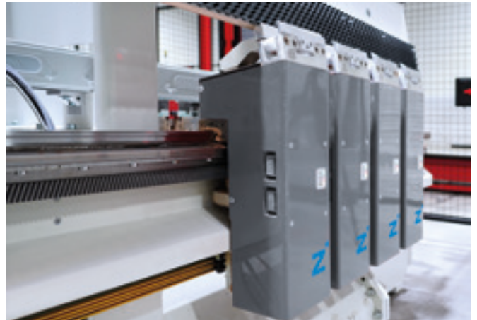
带循环移载模块的运输系统
