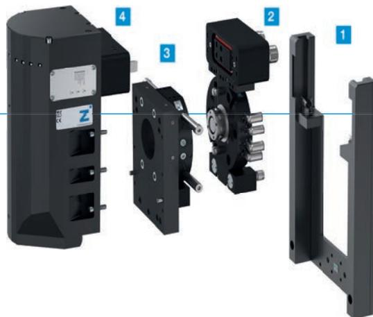
▶ 对于适合机械手应用的电机主轴,可提供专门设计的机械手更换单元。机械手更换单元构成了机械手和电机主轴之间的可靠接口。非固定端安装在电机主轴上,而固定件则安装在机械手臂的末端。在不使用时,有一个放置架可用于存放电机主轴。
