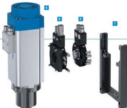
▶ Les unités de changement pour robot spécialement conçues sont disponibles pour les broches motorisées destinées à une utilisation robotisée. Les unités de changement pour robot constituent l'interface fiable entre le robot et la broche motorisée. La partie mobile est montée sur la broche motorisée, tandis que la partie fixe est montée à l'extrémité du bras robotisé. Un magasin est disponible pour ranger la broche motorisée lorsqu'elle n'est pas utilisée.
