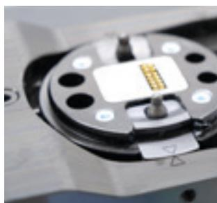
In modalità allestimento, i pin e le marcature ottiche nel deposito permettono un posizionamento semplice e univoco dell'end-effector. In funzionamento continuo, il pin scompare nel deposito e permette quindi un maggior grado di libertà durante il processo di cambio. Il deposito può in tal caso essere fissato in tre modi diversi.
