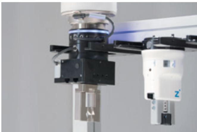
Cambio automatizzato (senza controllo esterno).
