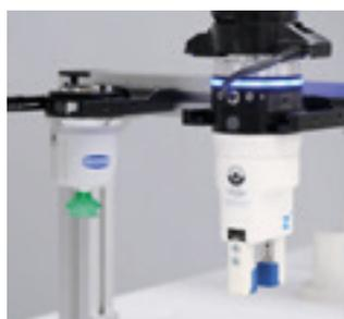
Un sistema antitorsione garantisce una posizione definita in modo univoco dell'end-effector nel deposito. Inoltre, anche durante il cambio manuale, viene assicurato che l'end-effector stesso sia collegato con lo stesso orientamento del robot.
