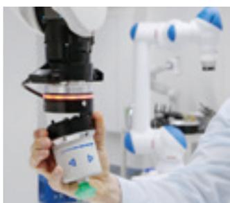
Il sistema di cambio rapido è abilitato per Hot-Plug e può essere commutato durante il funzionamento sotto tensione. L'elevata qualità della lavorazione e i materiali utilizzati (elementi di serraggio resistenti) garantiscono quindi una lunga durata utile (> 100.000 cicli).
