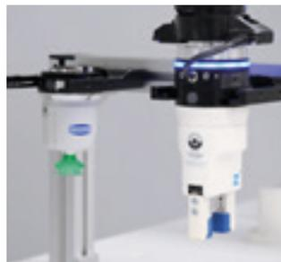
Une sécurité anti-rotation assure une position clairement définie de l'effecteur terminal dans le magasin. En outre, même lors d'un changement manuel, vous avez la garantie que l'effecteur terminal lui-même est connecté au robot dans la même orientation.
