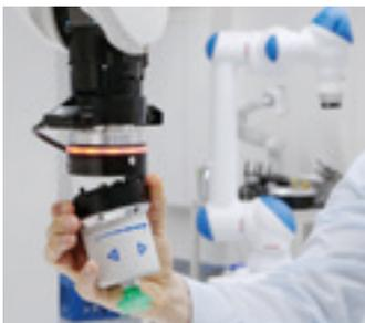
Le système de changement rapide peut être connecté à chaud et changé sous tension pendant le fonctionnement. La haute qualité de fabrication et les matériaux utilisés (éléments de verrouillage robustes) garantissent une longue durée de vie (> 100 000 cycles).
