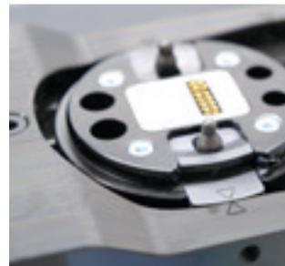
En mode de configuration, des broches et des repères optiques dans le magasin permettent un positionnement simple et clair de l'effecteur terminal. En mode continu, la broche disparaît dans le magasin, ce qui permet d'augmenter le degré de liberté durant le processus de changement. Le magasin peut être fixé de trois manières différentes.
