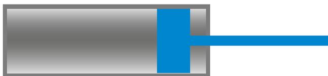
缓冲器 (集成有 复位装置)可直接装在五金件中,无需连接器,可自动移出。
