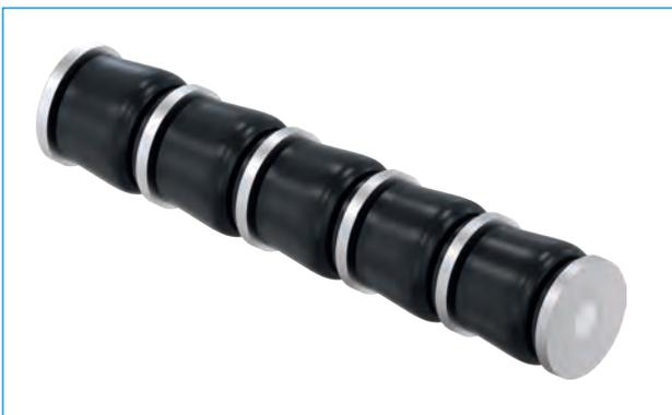
▶ Reihenschaltung von mehreren BasicStop Axial Standard inkl. integrierter Rundstangenführung zur Stoßdämpfung mit geringerer Stützkraft durch größeren Hub
