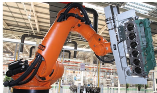
System chwytaków bloku silnika (600 kg) / załadunek i rozładunek na stanowiska montażowe
