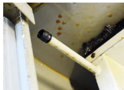
Amortyzacja drzwi maszyny w centrum obróbowym
