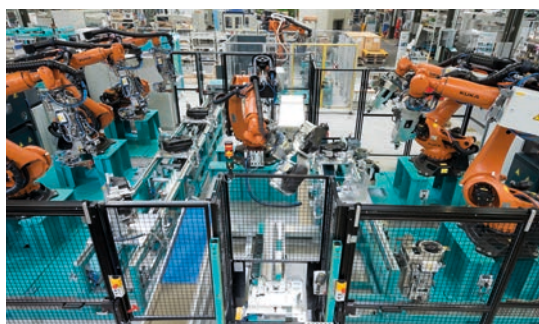
System chwytaków do zbiorników paliwa / załadunek różnych stanowisk montażowych
