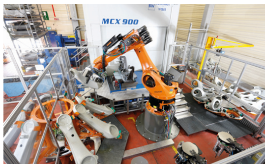
System chwytaków ze zmieniaczem narzędzi do części odlewanych i wrzeczona czyszczenia odlewu / załadunek i rozładunek dla centrum obróbki
