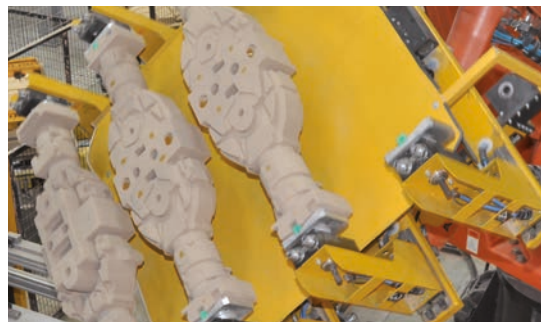
Sistema di pinze e di montaggio per anime di sabbia/prelievamento dalla macchina sabbia/anime
