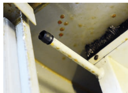
Ammortizzazione della porta della macchina in un centro di lavorazione
