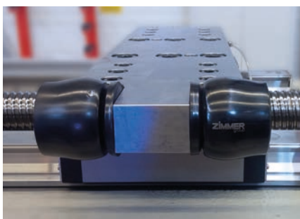
Decelerazione dei fine corsa negli assi lineari dei moduli di produzione dell'azienda ELHA
