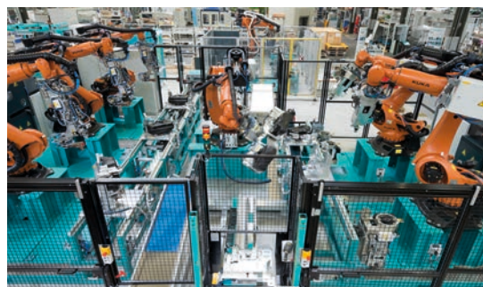
Sistema di pinze per serbatoi in plastica/carico di diverse stazioni di lavorazione
