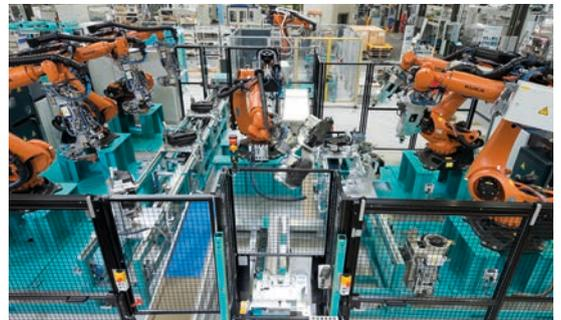
Sistema de agarre para depósitos de combustible / Carga de diferentes estaciones de mecanizado
