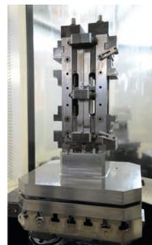
Placa de sujeción en una máquina de desprendimiento de virutas
