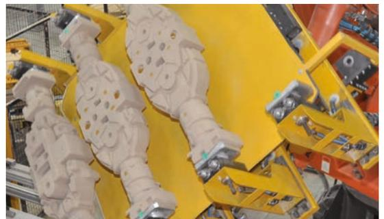
Sistema de agarre y montaje para moldes de arena / Extracción de la disparadora de machos
