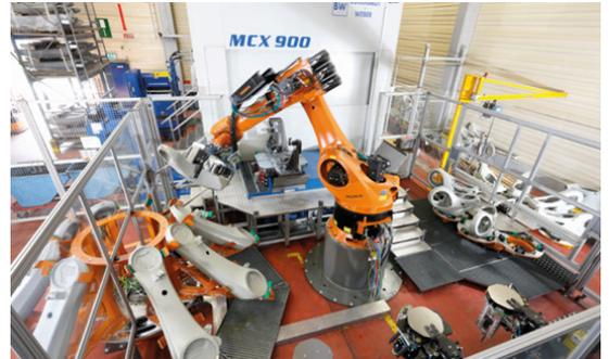
Sistema de agarre con cambiador de herramienta para piezas de fundición y husillo de desbarbado / Carga y descarga de centro de mecanizado
