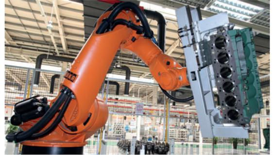
엔진 블록 그리퍼 시스템(600kg)/조립 스테이션에서 적재 및 하역
