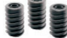
Bei Temperaturen zwischen 400 °C und 900 °C verdampft der Restbinder aus dem Bauteil. Die Metallpartikel verbinden sich, indem sie so genannte Sinterhalse ausbilden, und geben so dem Bauteil ausreichend Stabilität.
