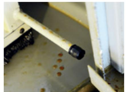
Dämpfung der Maschinentür in einem Bearbeitungszentrum
